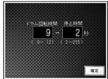
**回転停止 9-2** ……ドラム正逆回転時間、停止時間の設定をします。
