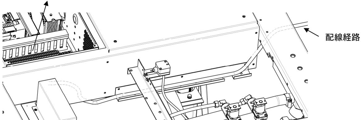
制御回路の配線は、電線の被覆をむいて棒状端子を使用してください。単線の場合は、電線の被覆をむいてそのまま使用できます。
