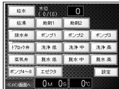
**給水** ……………スイッチを押すと給水弁が開き給水を行います。
