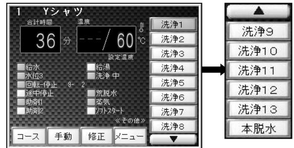
**運転** スイッチを押すと選択した工程から運転を開始します。
