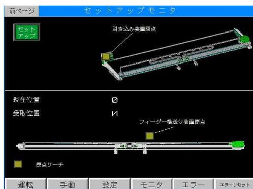
2秒長押しで、フィーダー横送り装置が原点サーチを、引き込み装置が前進又は後退（投入自動か手動かによる）します。動作中はランプが点滅表示します。
