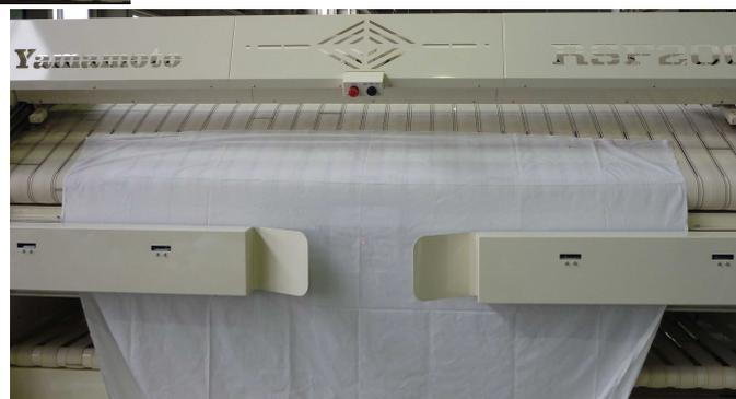
引き込み装置が後退するまでに一度でも一時停止すると、後退した状態を保持しますがキャンセルやシーツがロール入口センサーまで到達した場合は、引き込み装置とフィーダーが戻ってきますので注意してください。
