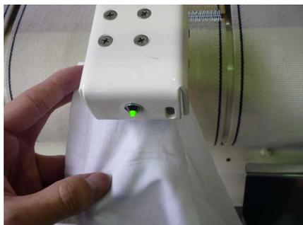
左右投入クランプにシーツを差し込むとセンサーが反応し、クランプが動作します。
