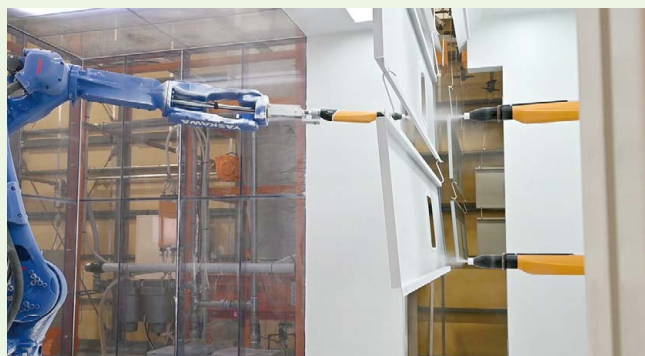
▲ロボットアームとレシプロで両面を同時に塗装
