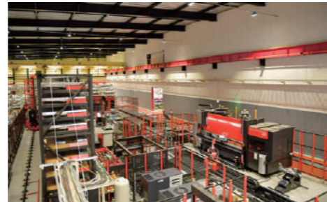
钣金加工线/实现全球首创从“模切”到“折弯”的自动化
